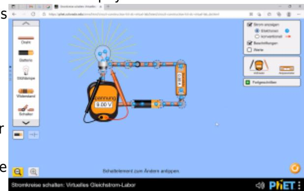
Es ist auch möglich Schalter einzubauen. Sobald man den Schalter schließt, schließt sich der Stromkreis und die Glühlampe leuchtet wieder. Sobald ich den Schalter öffne, ist der Stromkreis unterbrochen und die Glühlampe leuchtet nicht.
