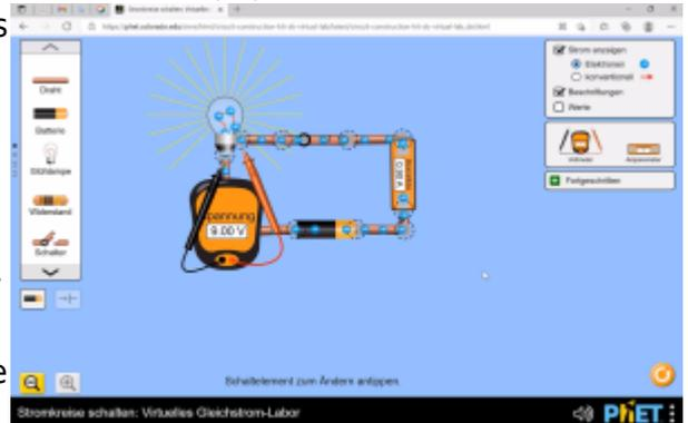
Es ist auch möglich Schalter einzubauen. Sobald man den Schalter schließt, schließt sich der Stromkreis und die Glühlampe leuchtet wieder. Sobald ich den Schalter öffne, ist der Stromkreis unterbrochen und die Glühlampe leuchtet nicht.
