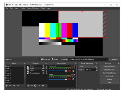
Neben der Aufnahme von Bildschirmhalten verfügt OBS auch über eine Live-Streaming Funktion. Ein Vorteil von OBS ist, dass verschiedene Szenen voreingestellt werden können, zwischen denen innerhalb der Aufnahme gewechselt werden kann. Außerdem kann auf eine Vielzahl von Quelle zugegriffen werden. Darüber hinaus können Sie den Funktionsumfang mit Hilfe von Plug-ins erweitern.
